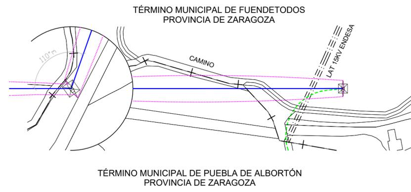
\* No se han encontrado datos topográficos sobre la altura de la LAT 15KV ENDESA en el proyecto original "PROYECTO DE EJECUCIÓN DE LA LÍNEA AÉREO-SUBTERRÁNEA DE ALTA TENSIÓN DE 220 KV SET MARÍAS-S.E. SECCIONAMIENTO PROMOTORES AVE ZARAGOZA". Se ha acotado la distancia de los cables de la línea proyectada al terreno en el punto de cruzamiento.
