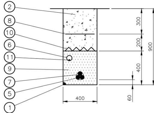
ZANJA PARA DOS CIRCUITOS 30 kV
