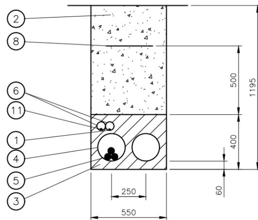
ZANJA PARA DOS CIRCUITOS 30 kV
