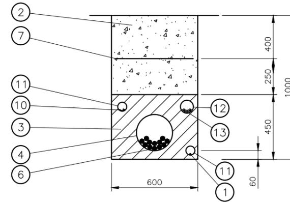
ZANJA PARA 12 CIRCUITOS BAJA TENSION EN ZONA DE TIERRA
