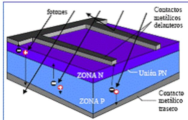
Las células fotoeléctricas transforman la energía solar en electricidad en forma de corriente continua, y ésta suele transformarse a corriente alterna para poder utilizar los equipos electrónicos que solemos disponer.
