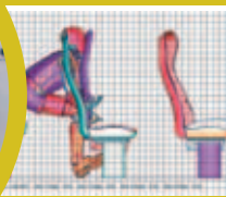
Test de impacto con dummies y simulaciones por ordenador CAF
