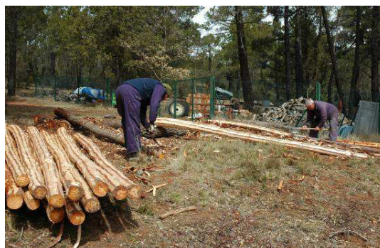
Pelando postes de pinos
