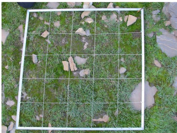
**Fotografía 1.6.** Cuadro de aluminio portable utilizado para las labores de seguimiento.
