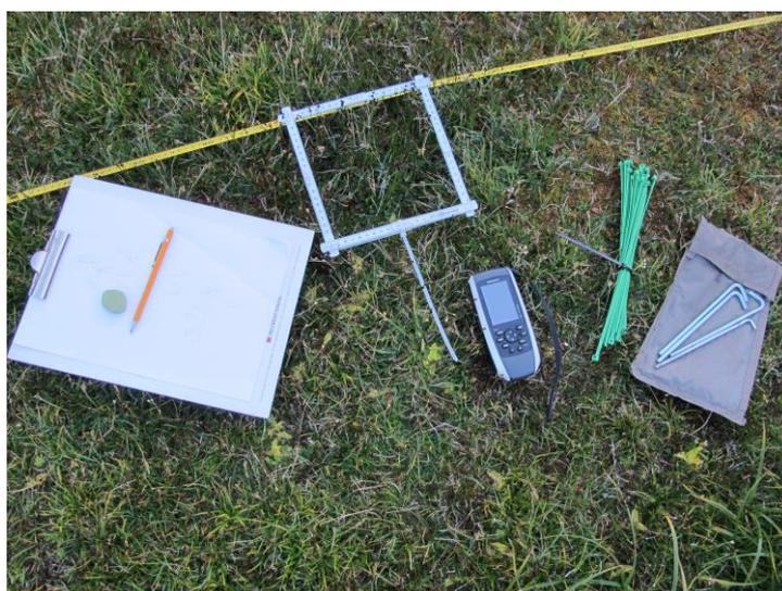
**Fotografía 1.8.** Material utilizado en el trazado y seguimiento de los transectos
