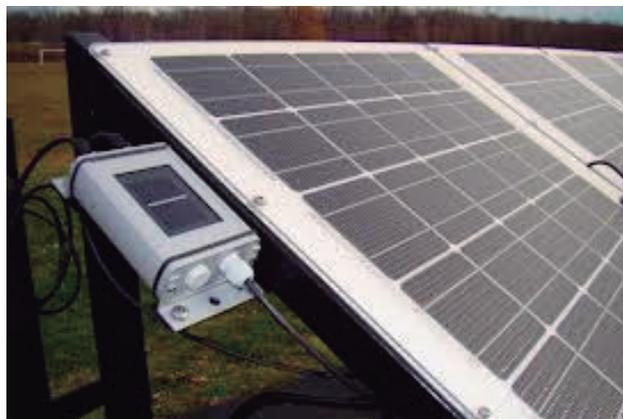
**Figura 31.** Sensor de irradiancia, IMT SOLAR, instalado al lado de un módulo solar [24]
