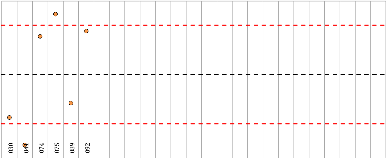
Gráfico 01 . Diagrama XY Dispersión de la media de cálculo según norma de ensayo ( m_{Arit} ). La línea de color negro marca el valor promedio y las de color rojo el promedio más/menos la desviación estandard respecto de la media.
