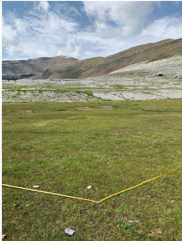
**Fotografía 1.9.** Cinta métrica colocada gracias a la marca fija en el terreno (clavo con arandelas)
