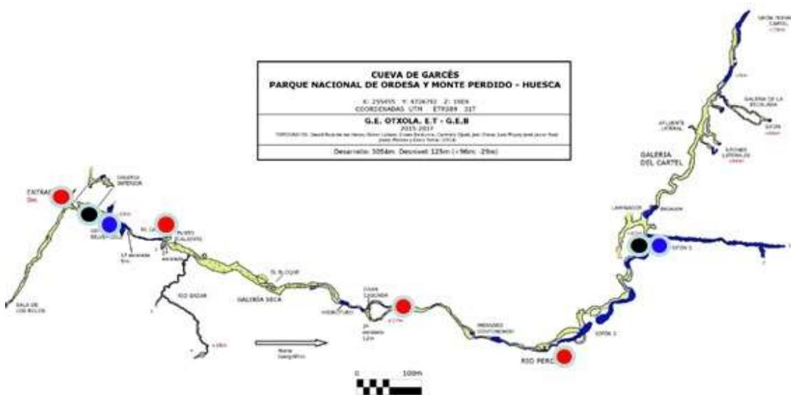
**Figura 3.1** Sensores de nivel (puntos azules), conductividad eléctrica (puntos negros) y temperatura (aire y agua; puntos rojos) instalados en distintos puntos de la Cueva Garcés.
