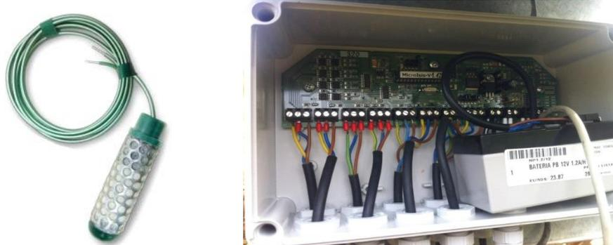
Sondas WATERMARK (A) y estación MicroSIS (B) utilizados para el seguimiento de la humedad del suelo en continuo.
