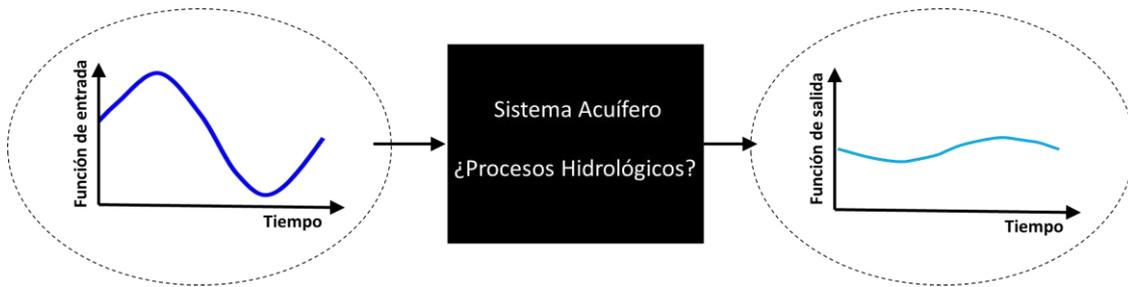
**Gráfico 2.2.** El sistema acuífero transforma la señal de entrada de la recarga en la señal de salida en la descarga a través de los manantiales. La señal de entrada puede ser de tipo hidroquímico, isotópico e hidrodinámico.
