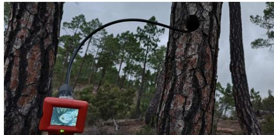
Revisión de una cavidad con cámara endoscópica
