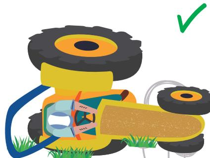
*El conductor queda retenido dentro de la zona de seguridad que proporciona la ROPS.*
