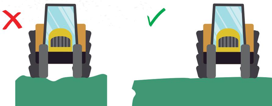
*Debe preverse un espacio suficiente en las proximidades de fosos o cunetas, para evitar el peligro de derrumbe o deslizamiento del terreno.*
