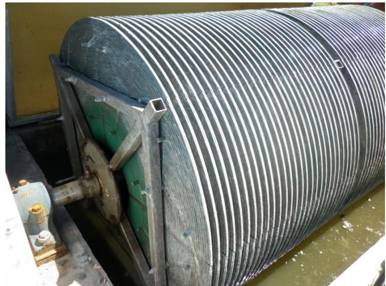
■ **Biocilindros:** el rotor consiste en una jaula cilíndrica perforada, que alberga en su interior un relleno de material plástico, al que se fija la biomasa bacteriana.
