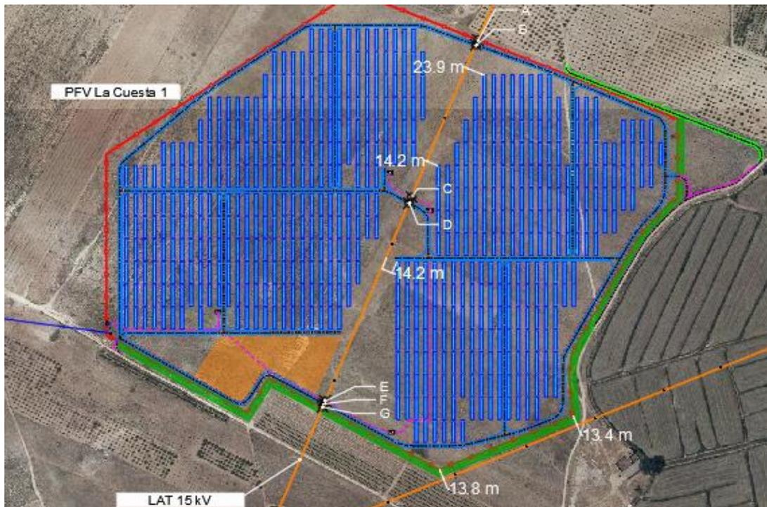
El vallado del PFV cruzará con la Línea Aérea de 15 kV, en las coordenadas UTM huso 30 ETRS89 de referencia que se detallan a continuación:
