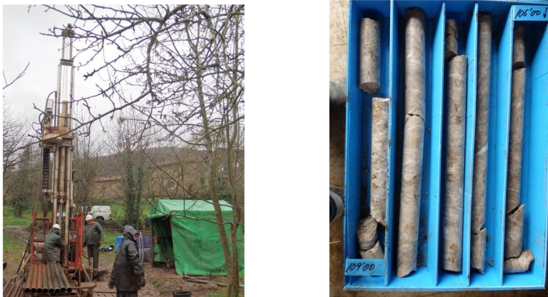
Figura 7- Perforación con recuperación de testigo y testigo recuperado (Campaña CEMEX 2022 en Asturias)
