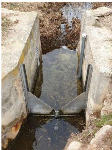
Fotos 9 y 10. Caudalímetros instalados.
