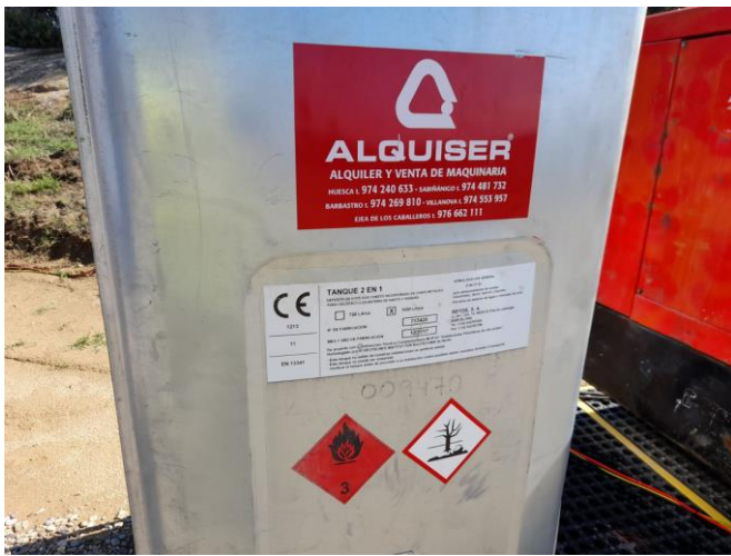
Fig. 1. Grupo electrógeno y contenedor de aceites y combustibles sobre cubeto de retención.
