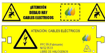
Ilustración 26. Detalle placa riesgo eléctrico
