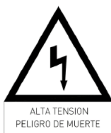
Ilustración 11. Ejemplo de señalización
