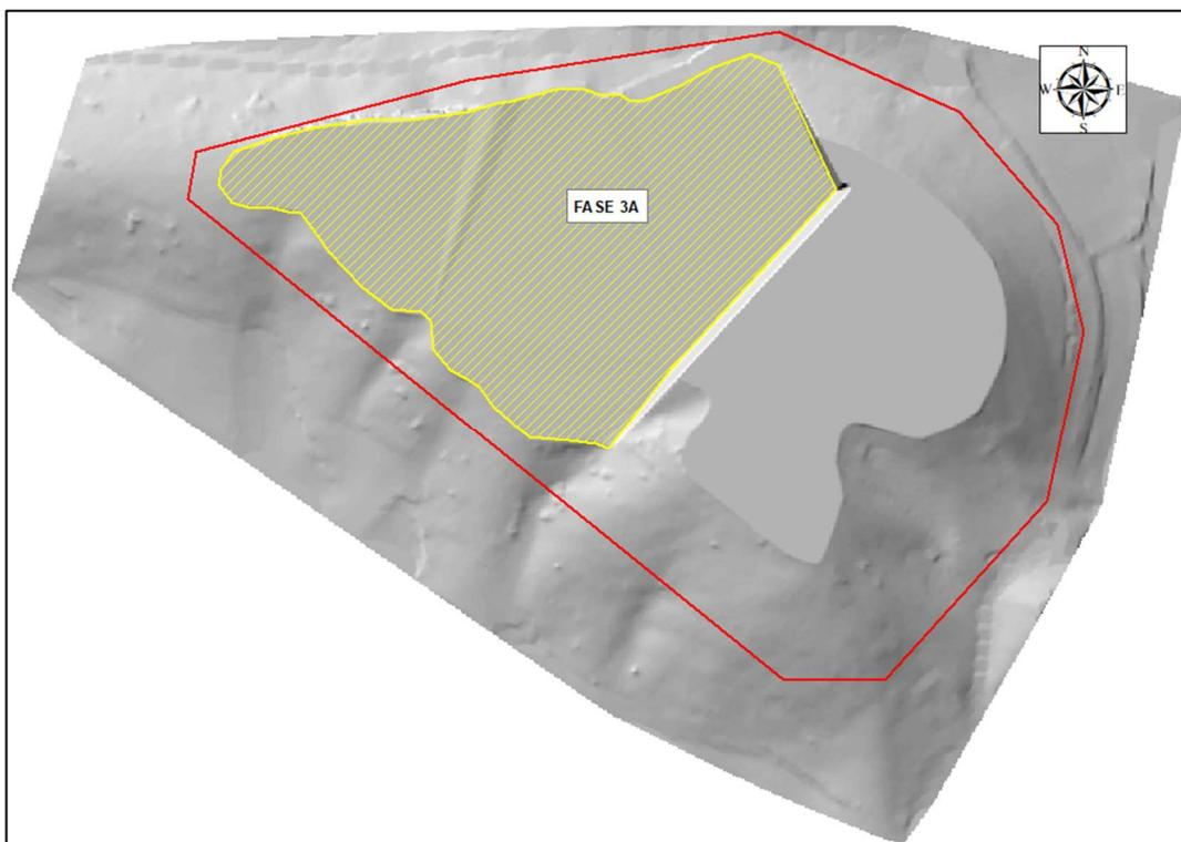
Gráfico 29º.- *Morfología del terreno tras la fase de explotación 3A. Puede llevarse a cabo la transferencia de estériles en la zona explotada en la fase 3A desde el momento en que se dispone de un terreno de unas 2 ha en la zona de inicio. La superficie total de la zona explotada en la fase 3A es 52.224 m<sup>2</sup>.*
