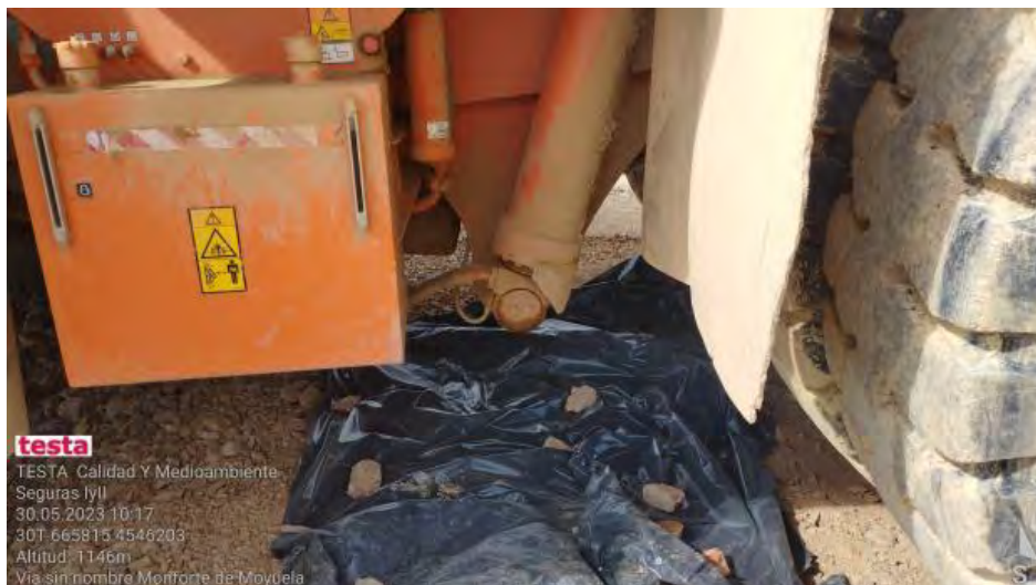
Fuga volquete solucionada parcialmente
