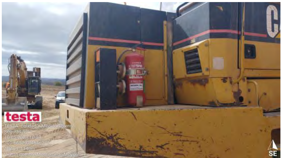
Extintores en maquinaria
