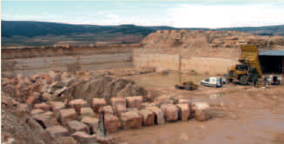
Cantera de piedra de la Puebla de Albornón. Los grandes bloques se procesan en “telares” de piedra que de una sola tongada los cortan en paneles de 3 cm de grosor
