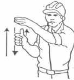
4 Levantar el aguilón o pluma lentamente
