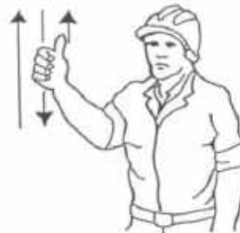
4 Levantar el aguilón o pluma lentamente
