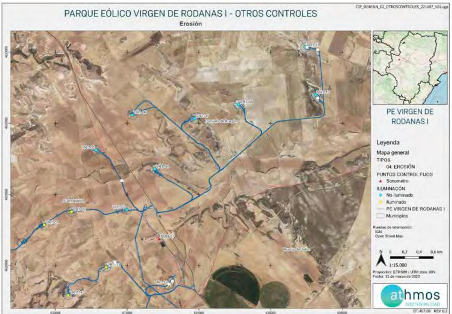
Fig. 1 Puntos detectados con degradación erosiva en el parque eólico Virgen de Rodanas I, del Clúster Valdejalón Norte. Fuente: Elaboración propia.
