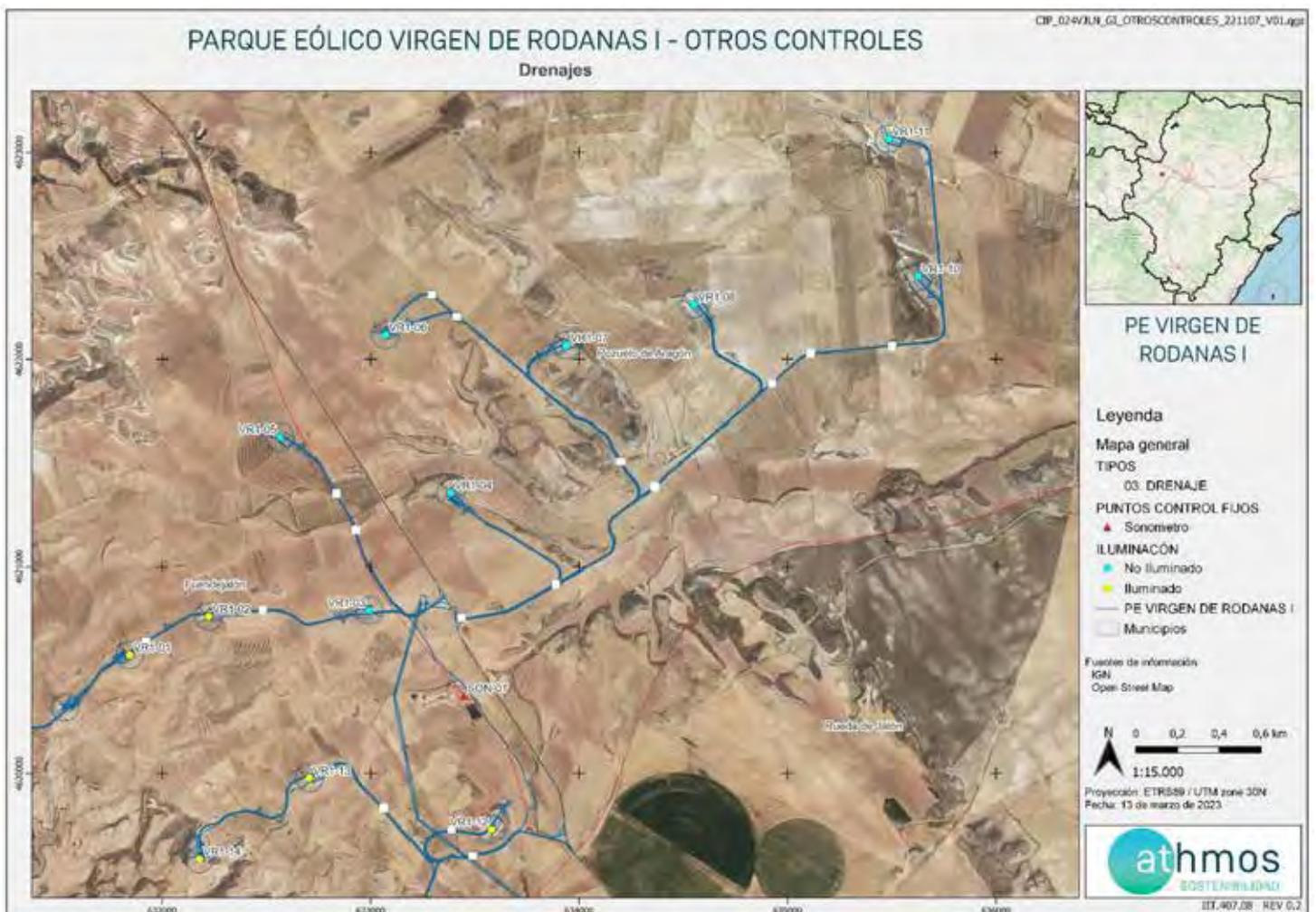
Fig. 1 Puntos detectados con drenajes deficientes o encharcamientos en el parque eólico Virgen de Rodanas I, del Clúster Valdejalón Norte. Fuente: Elaboración propia.
